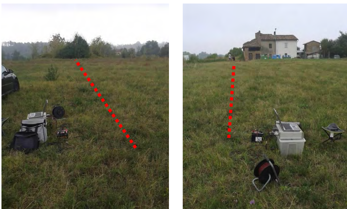
Figura 2. Stendimento sismico: geofoni dall'1 al 12 nella fotografia a sinistra e dal 13 al 24 a destra.
