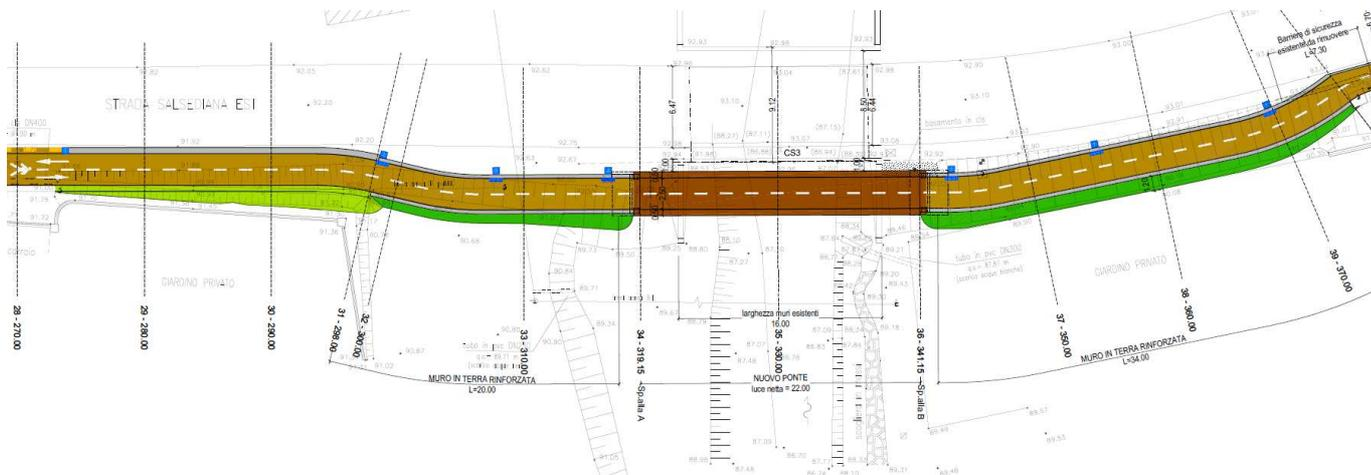
L'impalcato del nuovo ponte ha luce netta pari a 22.00m e si sviluppa dalla progr. 319.15m alla progr. 341.15m. Il ponte ha le spalle fondate su micropali, completamente indipendenti e adeguatamente distanziate dalla struttura del ponte stradale esistente.
